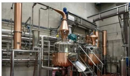
L'alambic utilisé pour la distillation des plantes aromatiques. Photo J.-F.M.
