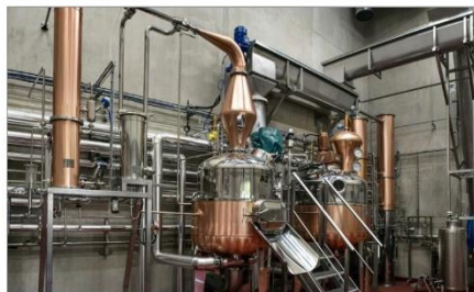
L'alambic utilisé pour la distillation des plantes aromatiques. Photo J.-F.M.
